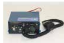
優秀賞第二席 トランジスタ3個で作った 6m QRP DSB トランシーバー (3TRX-6DSB2020) JR8DAG 菅野 正人さん
